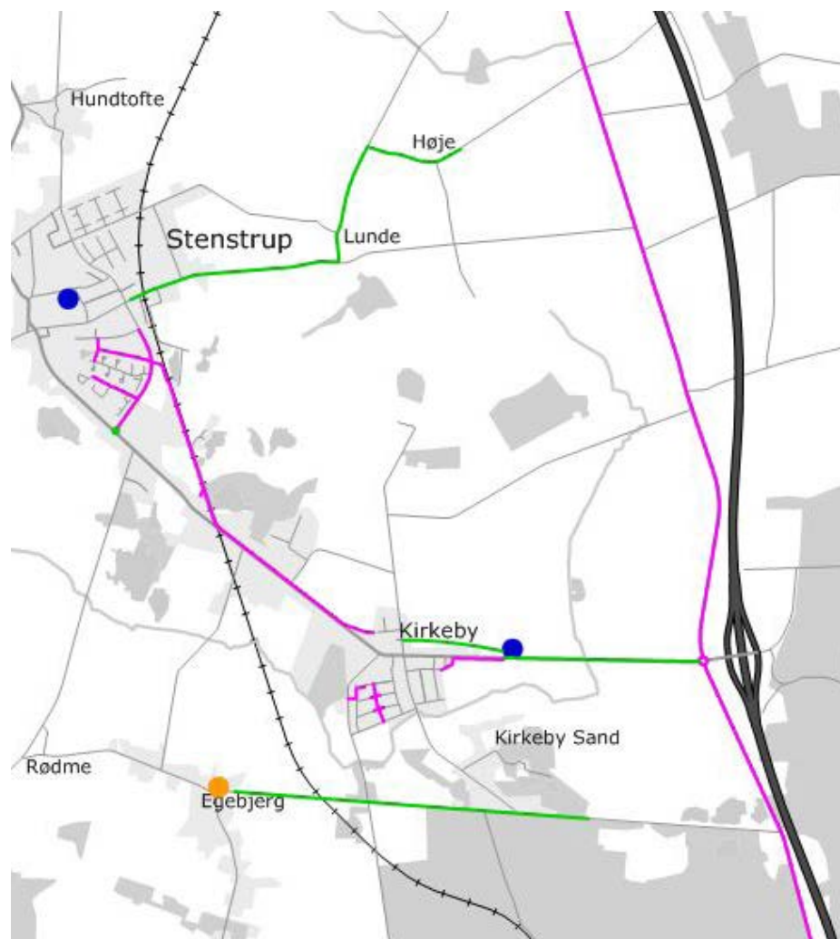
Kort over eksisterende cykelstier og cykelbaner (lilla) samt forslag til forbedringer af cykelrutenettet (grøn) - Stenstrup - Kirkeby - Egebjerg
